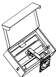
3. Відкрутіть монтажні гвинти, після чого від'єднайте ніжку від дисплея.
