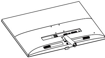
2. 用双手拿住底座支撑臂，用力将底座支撑臂插入底座支撑柱上。
