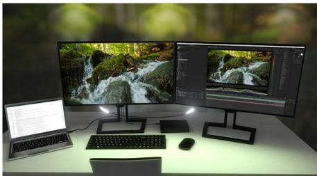
菊花链允许您从笔记本电脑上的单一 Thunderbolt 端口驱动多显示器和设备。从笔记本电脑的 Thunderbolt 端口连接到此显示器，然后可以从此显示器上的第二个 Thunderbolt 端口连接到第二个 4K 显示器。
