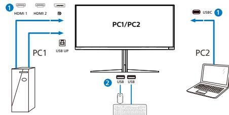
3. Accesați meniul OSD. Accesați meniul KVM și selectați „Auto”, „USB C” sau „USB Up” pentru a comuta controlul perifericelor de la un dispozitiv la celălalt. Repetați acest pas pentru a comuta sistemul de control folosind un set de periferice.
