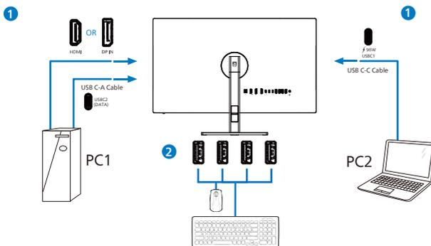
3. Rufen Sie das Bildschirmmenü auf. Rufen Sie die KVM-Ebene auf und wählen Sie zum Wechseln der Peripheriesteuerung von einem Gerät zum anderen „Auto“, „USB C“ oder „USB up“ (USB-Upstream). Wiederholen Sie diesen Schritt einfach, wenn Sie das Steuersystem über ein Set Peripheriegeräte umschalten möchten.
