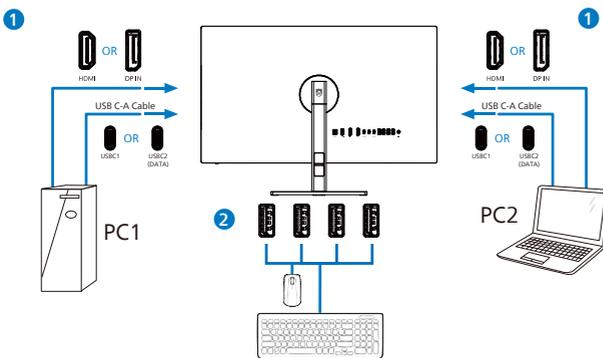
3. Rufen Sie das Bildschirmmenü auf. Rufen Sie die KVM-Ebene auf und wählen Sie zum Wechseln der Peripheriesteuerung von einem Gerät zum anderen „USB C“. Wiederholen Sie diesen Schritt einfach, wenn Sie das Steuersystem über ein Set Peripheriegeräte umschalten möchten.
