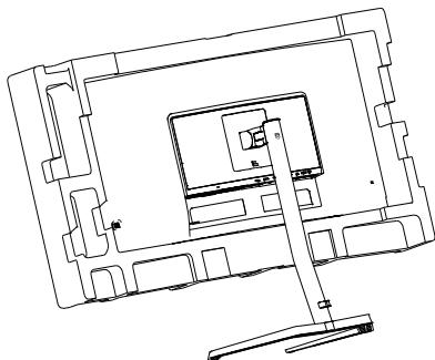
2. Нажав кнопку фиксатора, наклоните основание и извлеките его.
