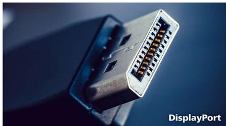
DisplayPort は、データを変換せずに PC からモニターへ転送するデジタルリンクです。DVI 基準よりも高い性能を持つこのポートは、最長 15 メ
