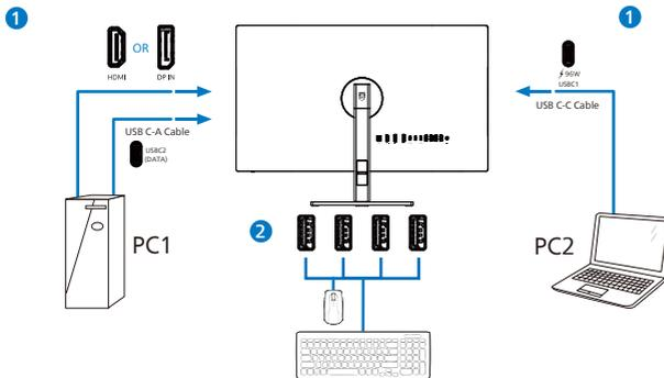
4. Accedere al menu OSD. Andare al livello KVM e selezionare "Auto", "USB C" o "USB up" per cambiare il controllo delle periferiche da un dispositivo a un altro. Basta ripetere questo passaggio per commutare il sistema di controllo usando un set di periferiche.
