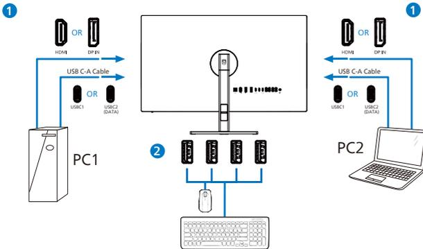
3. Accedere al menu OSD. Andare al livello KVM e selezionare "USB C" per cambiare il controllo delle periferiche da un dispositivo a un altro. Basta ripetere questo passaggio per commutare il sistema di controllo usando un set di periferiche.
