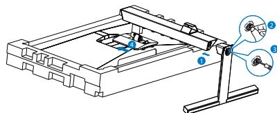
3. 安装底座后，用双手紧紧抓住显示器及塑料泡沫，竖起显示器。现在可以拔出泡沫塑料了。拔出泡沫塑料时，不要挤压面板，以免损坏面板。
