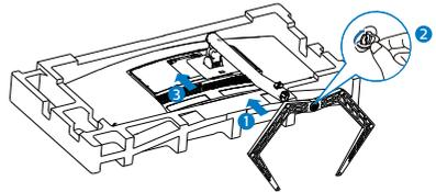
3. 安装底座后，用双手抓住与塑料泡沫紧扣在一起的显示器，使显示器直立。现在可以拔出泡沫塑料了。拔出泡沫塑料时，不要挤压面板以避免损坏面板。
