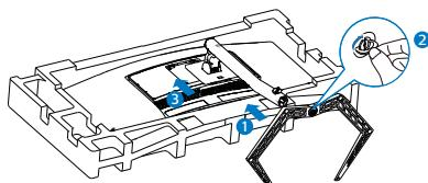
3. Po připevnění podstavce pevně uchopte monitor včetně fólie a postavte jej. Nyní můžete odstranit fólii. Při stahování fólie panel nesvírejte, aby se zabránilo jeho prasknutí.
