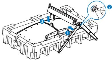
3. Después de unir la base, alce el monitor con las dos manos mientras sujeta el monitor con poliestireno. Ahora puede sacar el poliestireno. Cuando saque el poliestireno no comprima el panel para evitar romperlo.
