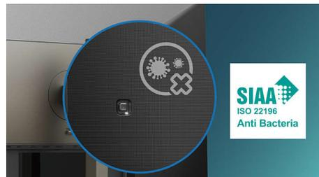
细菌通常通过受污染的接触表面进行传播。飞利浦显示器表面引入了经银离子处理的抗菌剂，可抑制细菌滋生、减少细菌在常接触部位的附着，以保持表面清洁和降低细菌传播。
