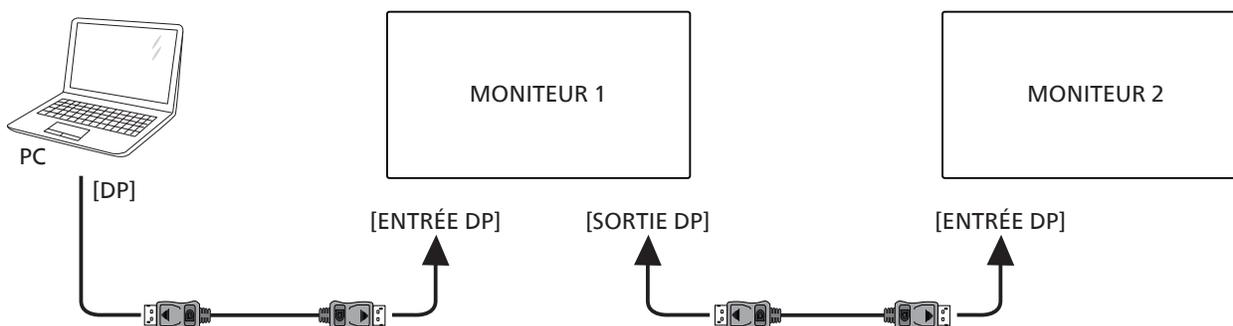
Connectez l'ordinateur portable [DVI] à [ENTRÉE DVI] du MONITEUR 1, connectez le connecteur [SORTIE DP] du MONITEUR 1 au connecteur [ENTRÉE DP] du MONITEUR 2.
