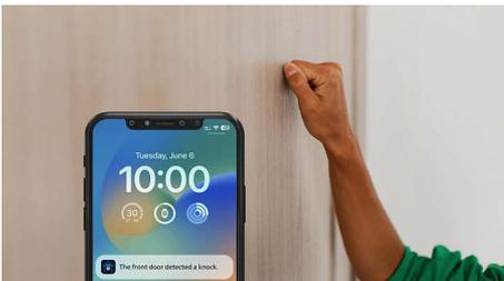
Un capteur intégré détecte d'éventuelles vibrations au niveau de la porte et alerte les propriétaires en envoyant des notifications à l'application Philips Home Access. Deux modes d'alerte vous permettent de savoir quand quelqu'un toque à votre porte ou porte des coups.
