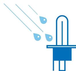
Solo una lámpara encendida fabricada con cristal de cuarzo (filamento a 2650 °C, cristal a 800 °C) puede soportar cambios bruscos de temperatura; por ejemplo, resiste sin explotar el goteo de agua fría sobre el cristal caliente de la lámpara, algo que puede suceder al conducir con una lámpara delantera rota y si hay agua en el entorno.
