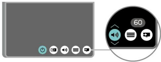
**3** - Нажимайте кнопки вверх/вниз, чтобы отрегулировать громкость или перейти на следующий/предыдущий канал. Нажмите кнопку перехода вверх или вниз для перемещения по списку источников, включающему выбор тюнера.
