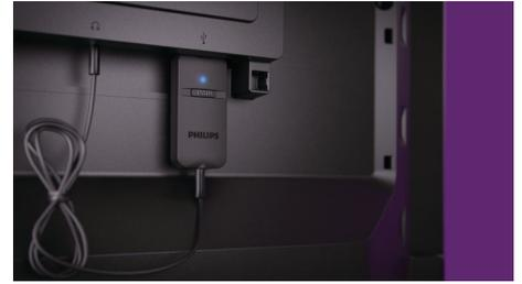
Il vous suffit de brancher le câble de 3,5 mm fourni sur la sortie casque de votre téléviseur et de connecter le dongle à l'autre extrémité du câble. Ensuite, branchez le dongle sur la prise USB du téléviseur. Pour vous connecter à votre PC, branchez le dongle sur la prise USB et sélectionnez la configuration audio adaptée.
