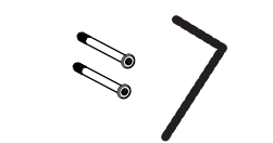
Βίδες και κλειδί Allen (για σύνδεση ηχείων μεγάλου ύψους)
