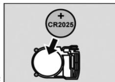
*Nota: Se o LED pisca quatro vezes sempre que carrega numa tecla, o telecomando está a indicar que a pilha está fraca. Substitua a pilha velha por uma pilha de lítio CR2025.*
