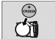
*Remarque: Si le voyant clignote quatre fois après chaque pression de touche, c'est que la télécommande indique que sa pile est faible. Remplacez la pile par une pile au lithium CR2025 neuve.*
