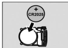
Bemærk: Hvis LED'en blinker fire gange efter hvert tryk på en knap, angiver fjernbetjeningen, at dens batteri er ved at være opbrugt. Udskift det gamle batteri med et CR2025 lithiumbatteri.
