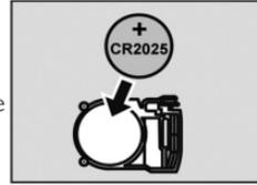
*Huom.: Jos merkkivalo vilkkuu neljä kertaa jokaisen näppäinpainalluksen jälkeen, kauko-ohjain osoittaa, että sen paristojen teho on alhainen. Vaihda vanha paristo uuteen CR2025 litium-paristoon.*
