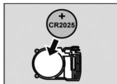
*Nota: Se il LED lampeggia quattro volte dopo ogni volta che si preme un tasto, il telecomando indica che la batteria si sta scaricando. Sostituite la vecchia batteria con una batteria al litio CR2025.*
