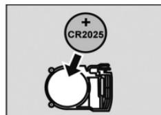
*Merk: Hvis lysdioden blinker fire ganger etter hver gang du trykker på en knapp, viser fjernkontrollen at batteriet nesten er utladet. Skift ut det gamle batteriet med et CR2025 litiumbatteri.*
