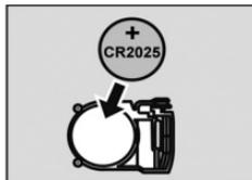
Obs: Om lampan blinkar fyra gånger varje gång en knapp trycks ner, anger fjärrkontrollen att batteriet börjar bli svagt. Byt ut det gamla batteriet mot ett litiumbatteri CR2025.
