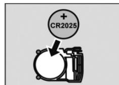
*Hinweis: Wenn die LED nach jeder Tastenbetätigung viermal blinkt, dann gibt die Fernbedienung an, dass ihre Batterie nahezu erschöpft ist. Ersetzen Sie die alte Batterie durch eine CR2025 Lithiumbatterie.*
