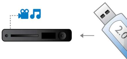
Der universelle serielle Bus, kurz USB genannt, ist ein Standardprotokoll für den problemlosen Anschluss von PCs, Peripheriegeräten und Unterhaltungselektronik. High-Speed USB-Geräte haben eine Datenübertragungsrate von bis zu 480 Mbit/s, im Gegensatz zu den 12 Mbit/s des ursprünglichen USB-Standards. Mit der High-Speed USB 2.0-Verbindung müssen Sie lediglich Ihr USB-Gerät anschließen, den Film, den Musiktitel oder das Foto auswählen und die Wiedergabe starten.
