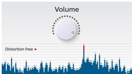
Функцията против изрязване ви позволява да възпроизвеждате музика по-силно и поддържа високото ѝ качество дори при нисък заряд на батерията. Тя приема входящи сигнали от 300 mV до 1000 mV и предпазва високоговорителите от повреда от изкривяване. Този високоговорител се справя с изрязването чрез отделна платка за ограничаване на аудиото. Тя следи музикалния сигнал, докато той преминава през усилвателя, и
