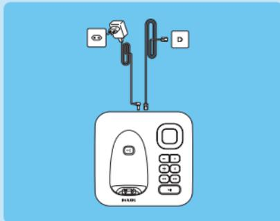
2. Подключите соединительный провод и провод электропитания к соответствующим разъемам на задней панели базовой станции.
