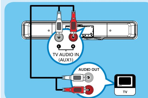
**Примечание** Для воспроизведения аудиосигнала от этого соединения последовательно нажмите AUX/DI /MP3 LINK, до отображения на индикаторной панели AUX1 INPUT.
