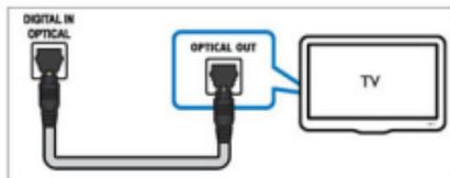
使用光纤线缆, 将回音壁上的 **OPTICAL** 接口连接至电视或其他设备上的 **OPTICAL OUT** 接口。
