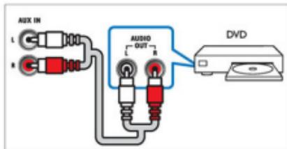
使用模拟电缆，将回音壁上的 **AUX** 接口连接至电视或其他设备上的 **AUDIO OUT** 接口。
