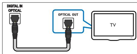
1 Si vous utilisez un câble optique, raccordez le connecteur **OPTICAL** du SoundBar au connecteur **OPTICAL OUT** du téléviseur ou d'un autre appareil.
