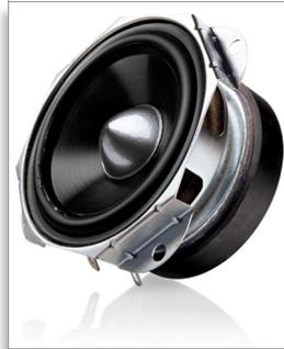
單一喇叭驅動器通常會造成振動膜邊緣產生特定的分頻震動，導致部分音效失真。在驅動器錐形筒周圍加上均勻、輕量的材質，通常就可解決此問題。在錐形筒周圍加上對稱的密封圈做隔音處理，即可有效減少不同步振動的現象產生，進而呈現更平衡、自然的音效。
