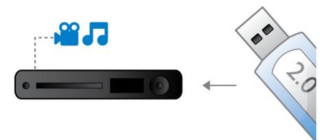
El bus serie universal o USB es un protocolo estándar para conectar ordenadores, periféricos y aparatos electrónicos de consumo. Los dispositivos USB de alta velocidad tienen una tasa de transferencia de datos de hasta 480 Mbps, a diferencia de los 12 Mbps de los USB originales. Gracias al enlace USB 2.0 de alta velocidad, todo lo que tendrás que hacer será conectar el dispositivo USB, seleccionar la película, música o fotografía y reproducir.
