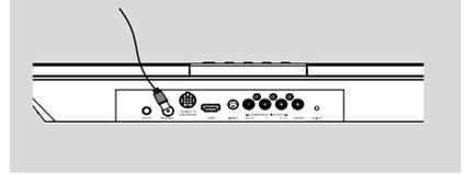
Conecte la antena FM suministrada al conector FM (75  $\Omega$ ). Extienda la antena FM y fije sus extremos a la pared.
