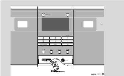
Deslice la cubierta protectora hacia abajo antes de conectar el dispositivo USB.
