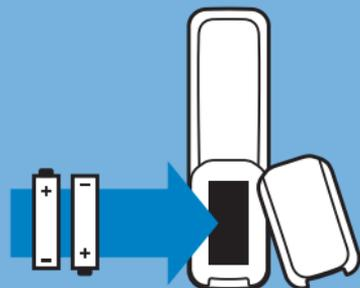
Die Akkus einsetzen und die Akkufachabdeckung schließen.
