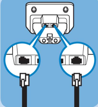
Das eine Ende des Telefon- und Netzkabels in die Buchsen auf der Rückseite der Basisstation stecken.
