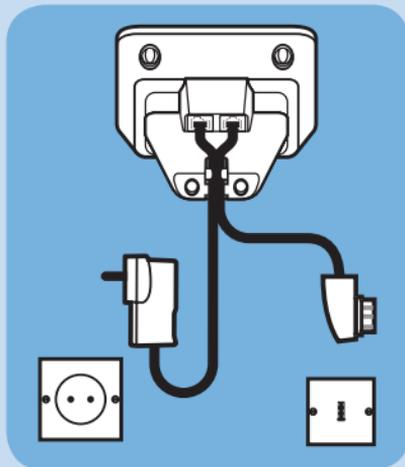
Das andere Ende der Kabel in die entsprechenden Steckdosen stecken.
