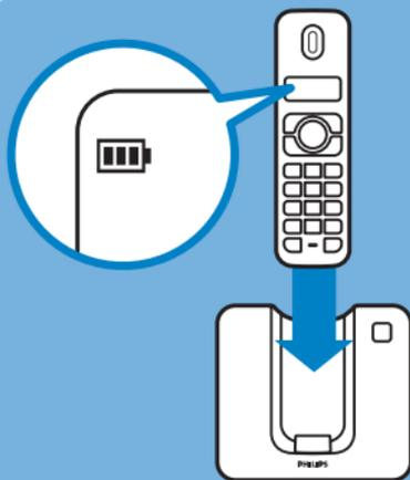
Das Mobilteil in die Basisstation stellen, um die Akkus aufzuladen. Das Akkusymbol wird angezeigt.
