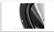
高度靈敏的布質喇叭圈將低音喇叭薄膜連接到喇 叭框架,形成一個環迴懸掛系統。當聲音訊號到 達低音喇叭內側的錐形筒時,布質喇叭圈配件將 錐形筒還原到適當位置,以準備接收另一個聲音 訊號。這樣,低音喇叭可以捕捉到每一個訊號, 並將聲音失真降至最低,從而提供清晰、流暢的 聲音,無論所播放的音樂的音量有多高或多低。
