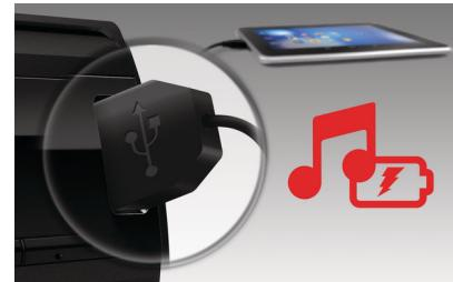
Novo univerzalno USB sučelje za punjenje tvrtke Philips pruža 1 A struje pametnom uređaju, što je dovoljno za punjenje baterije i napajanje za intenzivnu uporabu. Softverski protokol također je dizajniran da bude univerzalno kompatibilan s gotovo svim pametnim telefonima koji su dostupni na tržištu, a proces punjenja pokreće čim se USB poveže.
