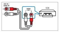
1 Verbinden Sie den AUX IN-Anschluss Ihres SoundStage über ein analoges Kabel mit den AUDIO OUT-Anschlüssen Ihres Fernsehers oder eines anderen Geräts
