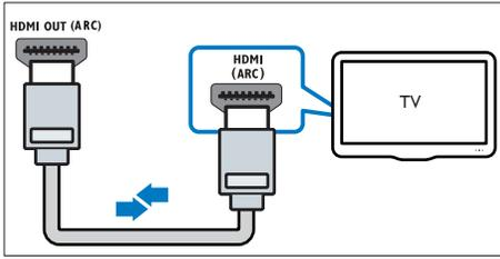
**1** Verbinden Sie den **HDMI OUT (ARC)**-Anschluss an Ihrem Home Entertainment-System über ein Hochgeschwindigkeits-HDMI-Kabel mit dem **HDMI ARC**-Anschluss am Fernseher:
