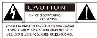
Cet « éclair » indique que le matériel non isolé à l'intérieur de l'appareil peut provoquer un choc électrique. Pour la sécurité de tous les membres de votre foyer, veuillez ne pas retirer la protection.
