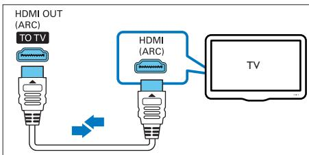
**1** С помощью высокоскоростного кабеля HDMI подключите разъем **HDMI OUT (ARC)** на продукте к разъему **HDMI ARC** на телевизоре.
