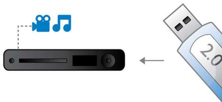
Универсальная последовательная шина, или USB - это стандартный протокол для удобной связи компьютеров, периферийных устройств и электронного оборудования клиента. Устройства Hi-Speed USB обеспечивают высокоскоростной перенос данных до 480 Мбит/с - по сравнению с 12 Мбит/с для обычных USB. Благодаря соединению Hi-Speed USB 2.0 все, что от вас потребуется, - это вставить устройство USB, выбрать фильм, фото или музыку - и нажать кнопку воспроизведения!
