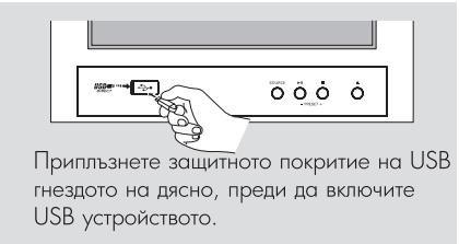
Припълзнете защитното покритие на USB гнездото на дясно, преди да включите USB устройството.
