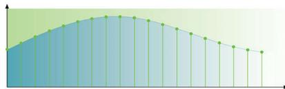
El muestreo a 192 KHz permite tener una representación precisa de las curvas de sonido originales. En combinación con una resolución de 24 bits, se captura más información de la forma de onda del sonido analógico original consiguiendo así una reproducción de audio mucho más rica.
