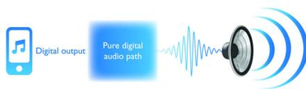
A maioria dos altifalantes de base utiliza a saída analógica do seu iPod, iPhone ou iPad e, em seguida, converte-a novamente para digital, isto resulta em algum ruído adicional e na perda de detalhes. Ao utilizar a saída digital do seu leitor, o altifalante mantém a integridade do sinal de música, resultando numa relação sinal/ruído mais elevada e numa melhor resolução.
