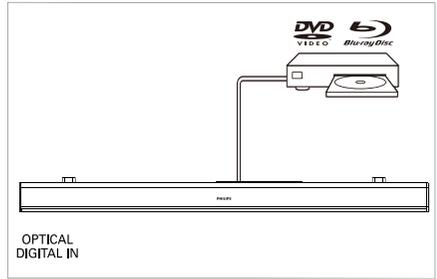
باستخدام كبل بصري، قم بتوصيل موصل OPTICAL الموجود على مكبر الصوت ب موصل OPTICAL الموجود على التلفاز أو أي جهاز آخر.
