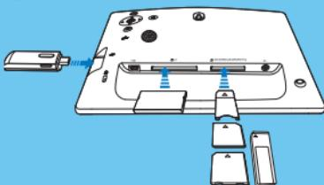
Inserire un dispositivo di archiviazione in modo che rimanga saldamente in posizione.
