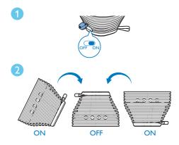
1 Impostare l'interruttore a scorrimento su ON per attivare il sensore automatico.
