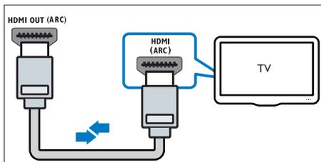
1 Si vous utilisez un câble HDMI haute vitesse, raccordez le connecteur **HDMI OUT (ARC)-TO TV** de votre SoundBar au connecteur **HDMI ARC** du téléviseur.
