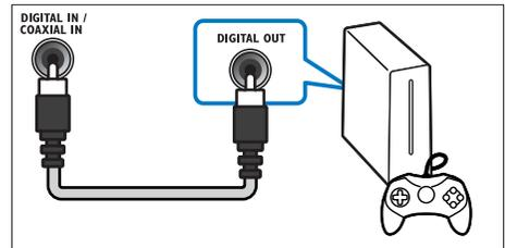
1 Si vous utilisez un câble coaxial, raccordez le connecteur **COAXIAL** du SoundBar au connecteur **COAXIAL/DIGITAL OUT** du téléviseur ou d'un autre appareil.
