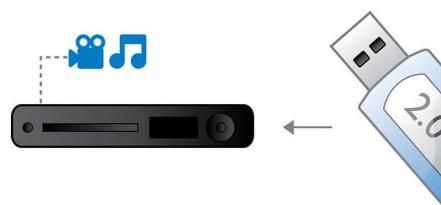
Универсальная последовательная шина, или USB — это стандартный протокол, используемый для удобной связи ПК, периферийных устройств и бытовой электроники. Устройства Hi-Speed USB обеспечивают перенос данных со скоростью до 480 Мбит/с — по сравнению с 12 Мбит/с для обычных USB. Благодаря Hi-Speed USB 2.0 Link все, что от вас потребуется, — это вставить устройство USB, выбрать фильм, фото или музыку — и нажать кнопку воспроизведения!
