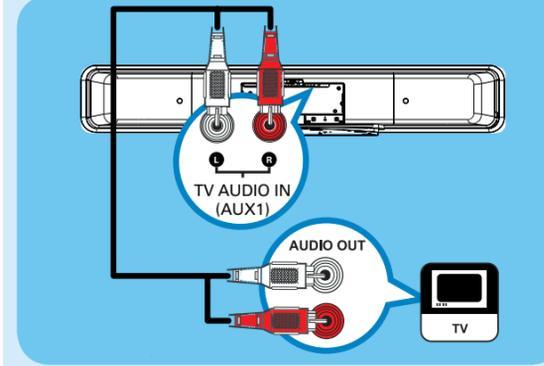
**Not** Ses çıkıřını bu baęlantıdan almak için, **AUX/DI / MP3 LINK** görüntülenene kadar, gösterge panelindeki 'AUX1 INPUT' düęmesine arka arkaya basın.
