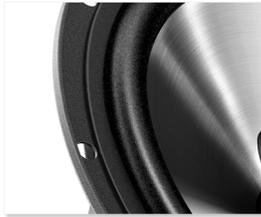
高度靈敏的布質喇叭圈將低音喇叭薄膜連接到喇叭框架，形成一個環迴懸掛系統。當聲音訊號到達低音喇叭內側的錐形筒時，布質喇叭圈配件將錐形筒還原到適當位置，以準備接收另一個聲音訊號。這樣，低音喇叭可以捕捉到每一個訊號，並將聲音失真降至最低，從而提供清晰、流暢的聲音，無論所播放的音樂的音量有多高或多低。
