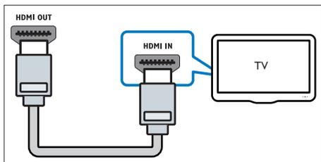
**1** За допомогою високошвидкісного кабелю HDMI з'єднайте роз'єм **HDMI OUT (ARC)** на системі домашнього кінотеатру з роз'ємом **HDMI** на телевізорі.
