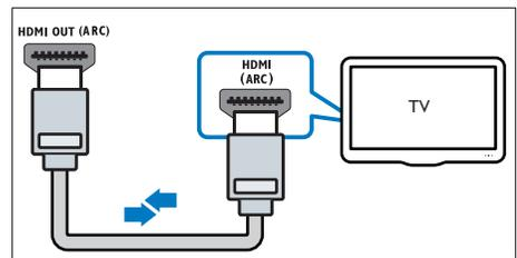
**1** За допомогою високошвидкісного кабелю HDMI з'єднайте роз'єм **HDMI OUT (ARC)** на системі домашнього
