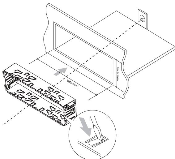
**3** 用随附的拆卸工具拆除安装机套。
