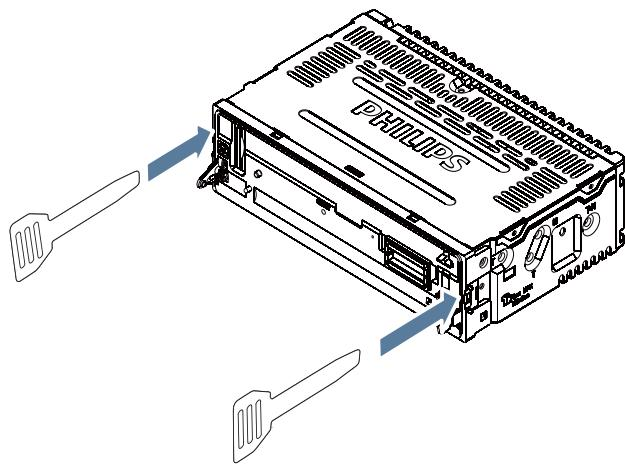
**4** 将机套装入仪表盘，向外弯曲卡舌以固定机套。
