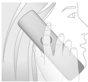
Для дополнительного комфорта задняя панель телефонной трубки имеет специальное текстурное покрытие.
